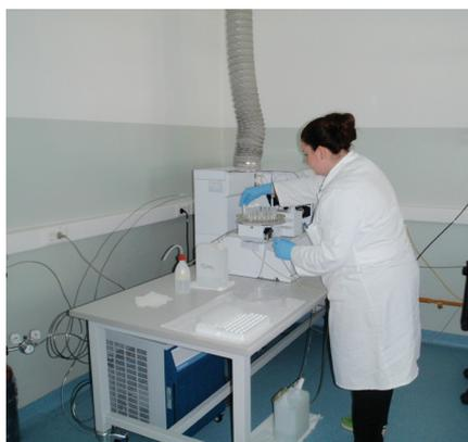
Spektrometar masa uz induktivno spregnutu plazmu (ICP-MS)
