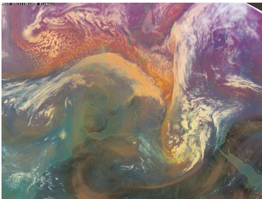
Slika 2.28. Airmass RGB iz podataka Meteosat 10 satelita za 6. studenog 2013. u 12 UTC. Airmass RGB kombinira razliku kanala 6,2 - 7,3 \mu\text{m} u crvenom snopu, razliku kanala 9,7 - 10,8 \mu\text{m} u zelenom te kanal 6,2 \mu\text{m} u plavom dijelu spectra
