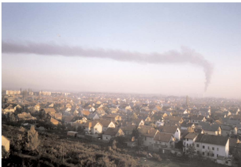
Slika 3.43. Dimnjak visine 202 m izračunat je za dvije termoelektreane u Zagrebu na osnovi proračuna disperzijskim modelom koji je morao zadovoljiti uvjet da u zimskim mjesecima struja emitiranih plinova probija sloj temperature inverzije kako bi se spriječilo zadržavanje štetnih spojeva na području Zagreba i izloženost stanovnika visokim koncentracijama dušikovih spojeva i lebdećih čestica. Visina širenja perjanice plinova prikazana na slici za siječanj bila je kojih 800-900 m dok se sloj inverzije pratio do visine od kojih 250 m. ELTO Žitnjak (siječanj 1999.)
