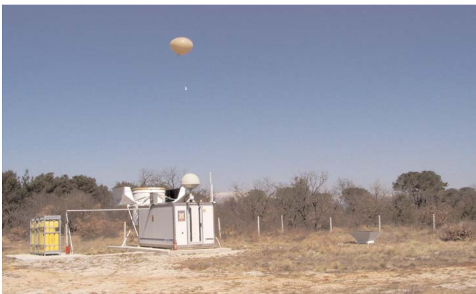
Slika 2.17. U potpunosti automatizirani radiosondažni uređaj Vaisala-Autosonde na lokaciji Zadar-Zemunik
