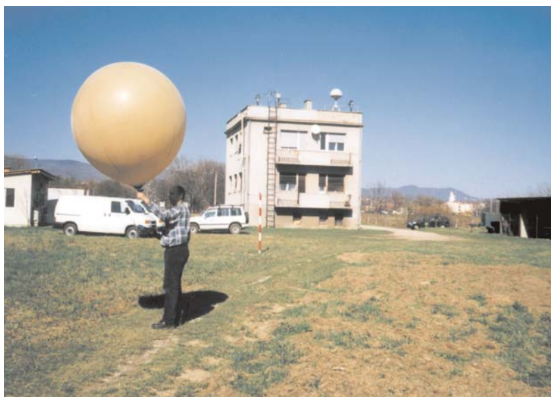
Slika 2.15. Radiosondažna mjerenja na Meteorološko-aerološkom opservatoriju Zagreb-Maksimir (1998.)
