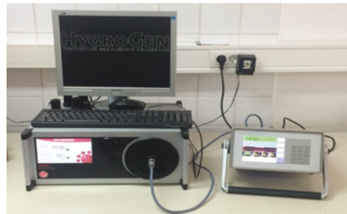
Referentni sustav za umjeravanje mjerila relativne vlažnosti zraka (lijevo) i masenog protoka (desno)
