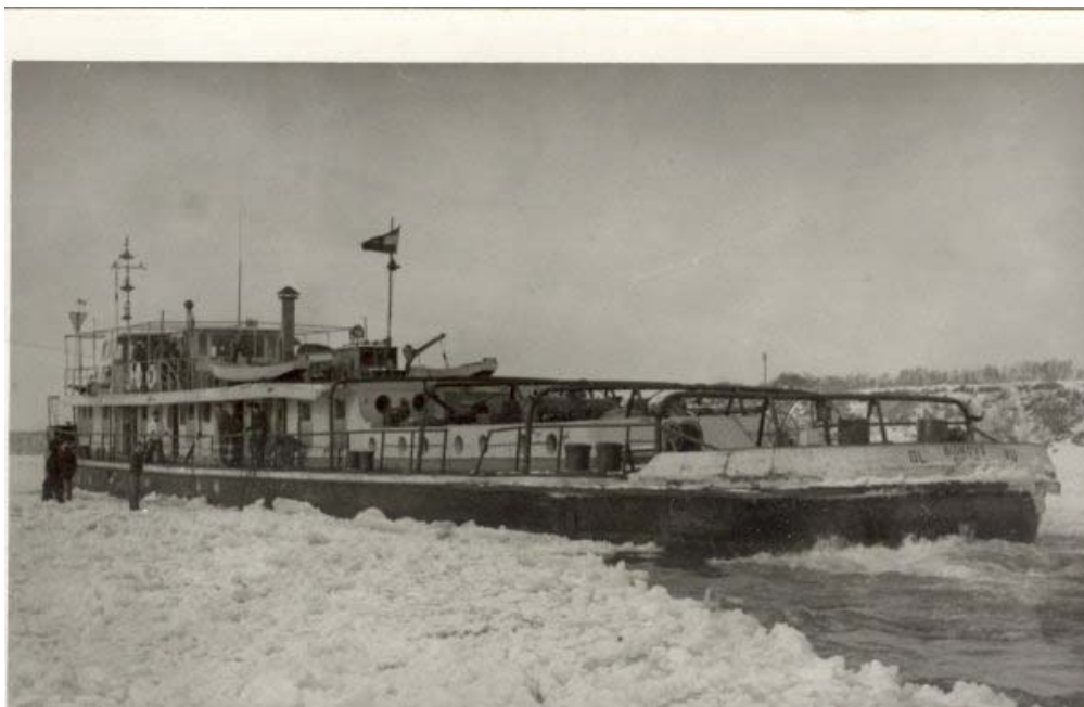
Brod Biokovo zarobljen u ledu, Sava kod Ruščice (Slavonski Brod), 17.01.1985. Debljina leda oko 30 cm, H=173 cm, Q=637 m 3 /s; najniža temperatura zraka -25,2 °C 12.01.1985.
