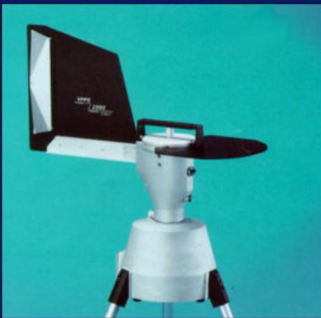
Volumetrijski uzorkivač za pelud Hirstovog tipa radi na principu usisavanja zraka čije se čestice ljepe na traku koja se kasnije mikroskopira.
