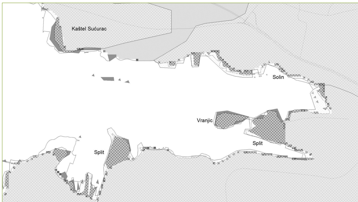
Slika 5-5: Prikaz poplavljenog kopna nakon porasta razine mora od 0,50 metara (svjetlosiva) i od 0,88 m (tamnosiva) u sjevernom dijelu Splita. (Mreža označava naseljeno područje)
