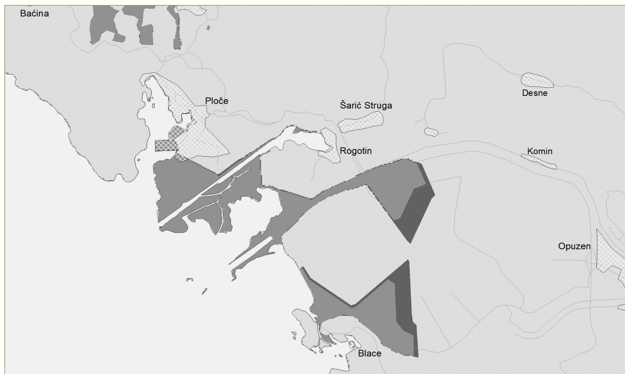
Slika 5-3: Poplavljeno područje doline rijeke Neretve nakon porasta razine mora od 0,50 m (svjetlosiva) i 0,88 m (tamnosiva). (Mreža označava naseljeno područje)
