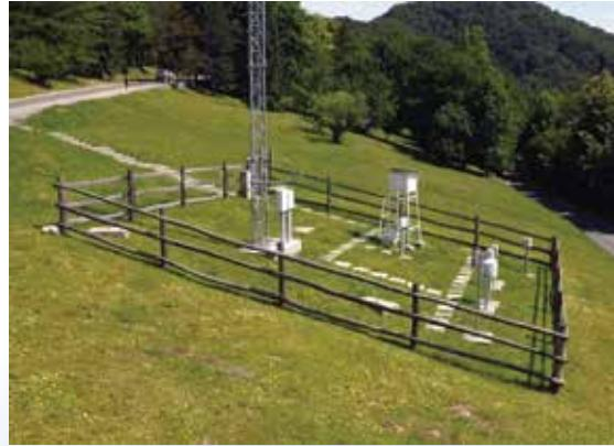
**Meteorološka postaja** je posebno odabрано i opremljeno mjesto na kojem se sustavno izvode meteorološka motrenja, prema standardima Svjetske meteorološke organizacije. Postoje različite vrste postaja ovisno o opremljenosti, osposobljenosti i broju motritelja, namjeni i sl.
