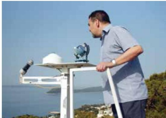
**Motrenje** je standardizirani postupak dobivanja više meteoroloških podataka mjeranjem i opažanjem, ovisno o meteorološkom elementu i raspoloživim instrumentima. Motrenja se obavljaju obično u standardnim terminima.
