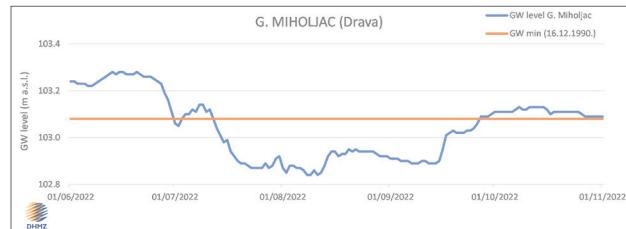
**Slika 5.2.13. Razina podzemne vode (RPV) u pjezometru Gornji Miholjac za razdoblje 1. 6. – 31. 10. 2022. prati niske vodostaje Drave, što je rezultiralo novim absolutnim minimumima RPV-a (ispod crvene linije).**
