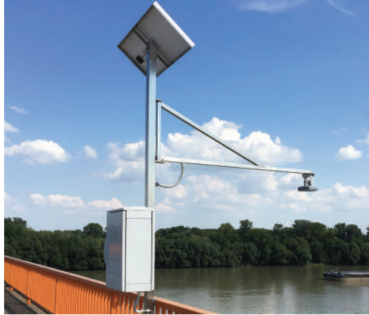
Mjerna postaja na kojoj se vodostaj mjeri radarskim uređajem sa solarnim napajanjem
