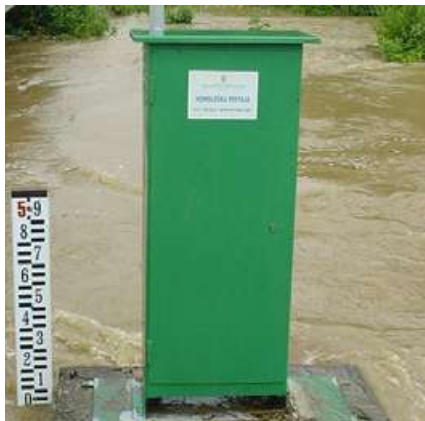
Mjerna postaja na kojoj se vodostaj mjeri limnigrafom
